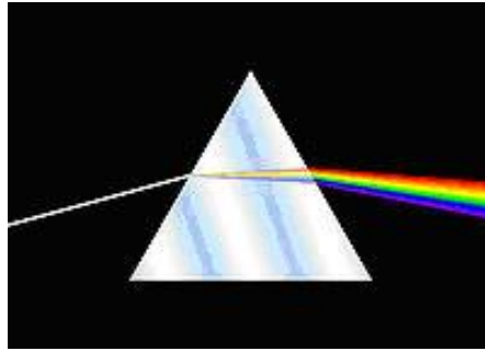
Slika 1 Lom bele svetlobe na optični prizmi
